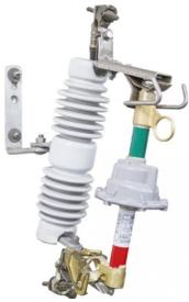
El seccionalizador cuenta las operaciones del equipo de protección después de detectar una condición de falla. Después de un número seleccionado de aperturas del equipo de protección asociado y cuando éste está abierto, el seccionalizador abre y aísla la sección en falla de la línea.
